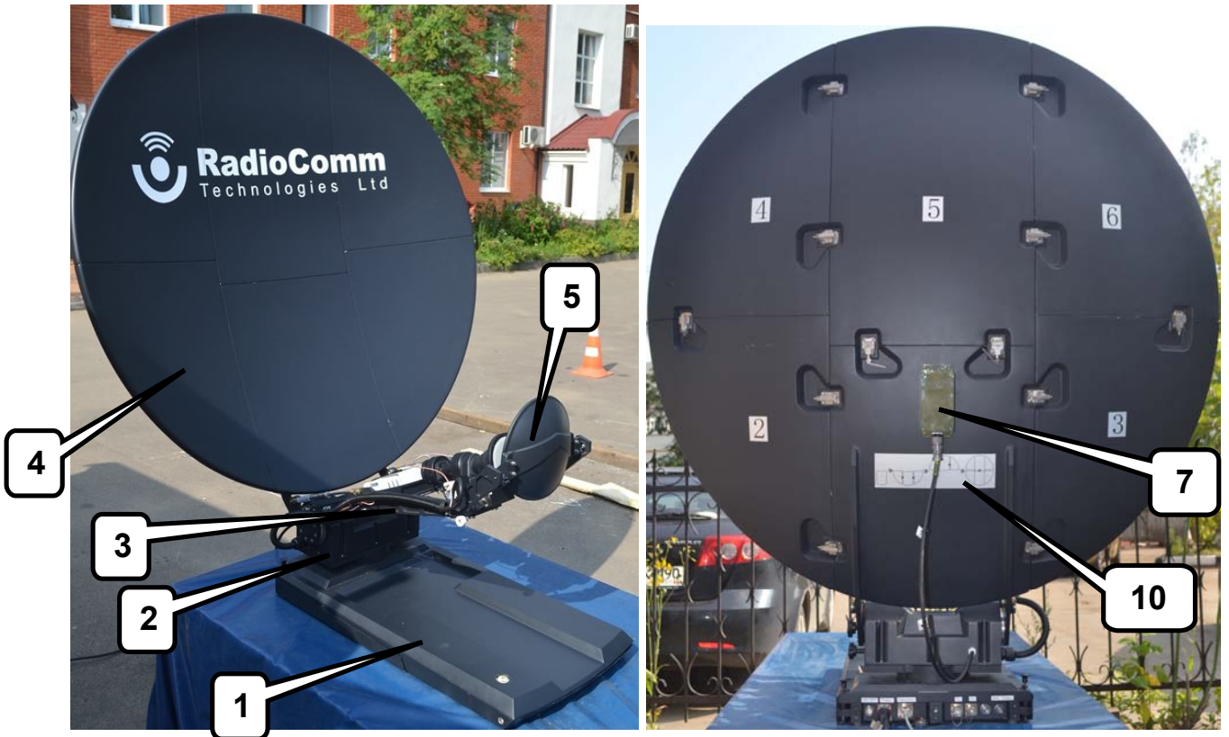
Рисунок 1.2.1 - Внешние виды Антенного устройства 1.2 м
