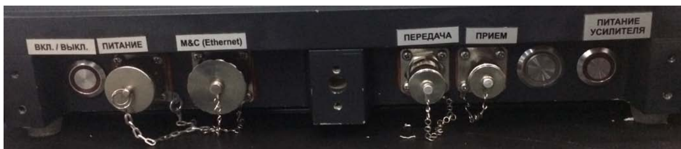
Рисунок 1.2.3 - Внешний вид АУ со стороны задней панели
