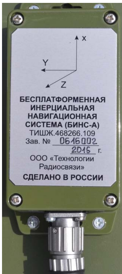
Рисунок 1.2.6 – Внешний вид БИНС-А ТИШЖ.468266.109
